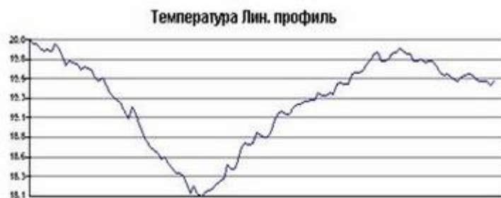
Рис.2. Линейный профиль температур в области дефекта утеплителя.
